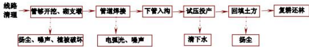
图 3-1 管道敷设施工流程及产污示意图
