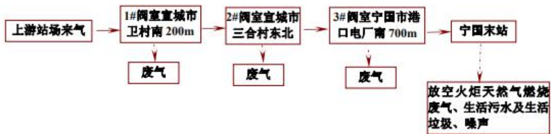
图 3-2 运营期工程总流程及产污示意图
